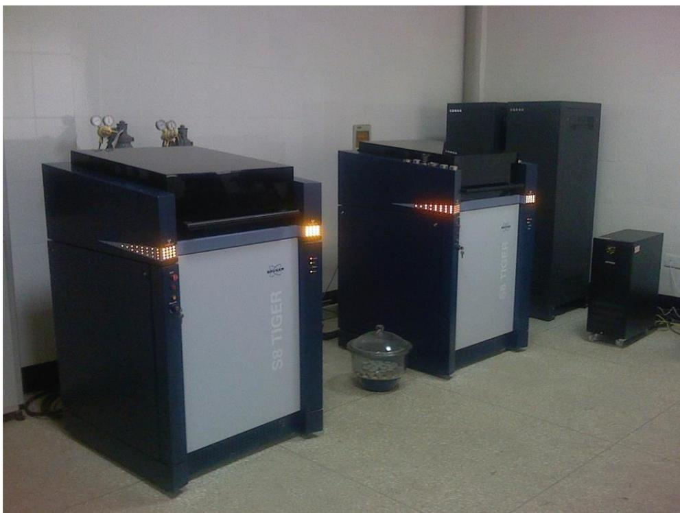
图 1 二台 S8 Tiger 型 X 射线荧光光谱仪
